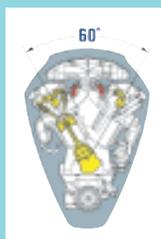
La compacité du bloc moteur en V à 60° permet un montage facile des moteurs, notamment pour les multiples motorisations.
